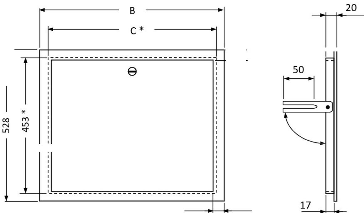
\* - Einbaumasse für minimalen Mauerausschnitt
